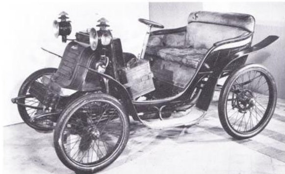
Der erste Gräf-Wagen mit Vorderradantrieb, 1900. Als Antrieb dient ein einzylindriger, wassergekühlter stehender 3\frac{1}{2} -PS-De Dion-Motor. Ausgestellt im Wiener Technischen Museum.
