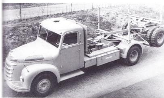
LVT 8 mit aufgezäumtem Nachläufer für Holztransporte.
